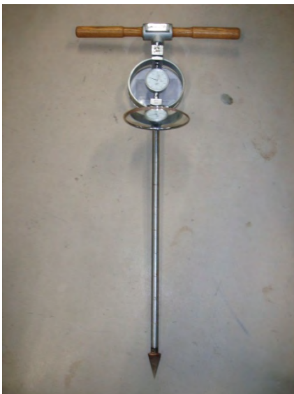
写真-2.5 ポータブルコーン貫入試験機
