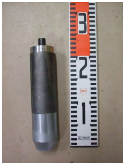
写真-5.1 サンプラーの模型
