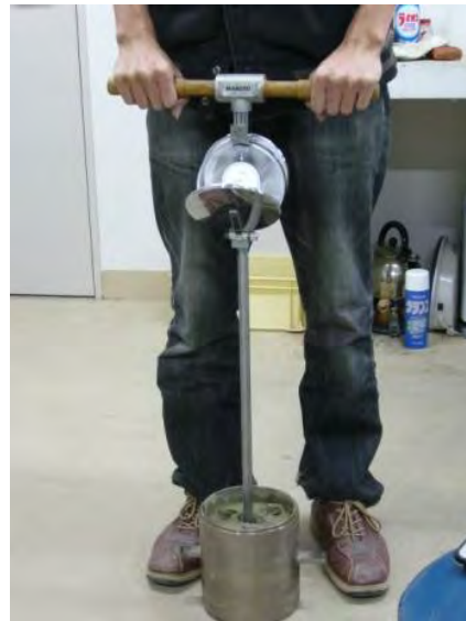
写真-2.6 貫入試験
