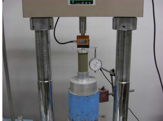
写真-2.4 一軸圧縮試験
