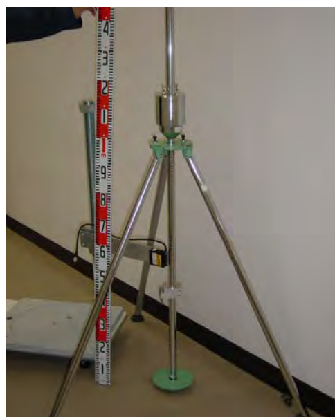
写真-3.1 簡易動的コーン貫入試験装置
